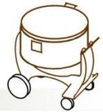
MecoConcept a sélectionné pour vous des malaxeurs que qualité compatible avec le malaxage de la terre à BTC. En effet, Le malaxage est une étape essentielle de la fabrication des BTC, car l'outil doit être capable de répartir l'eau de manière homogène dans la préparation, sans casser la granulométrie. Tous les malaxeurs à Béton n'en sont pas capables.
